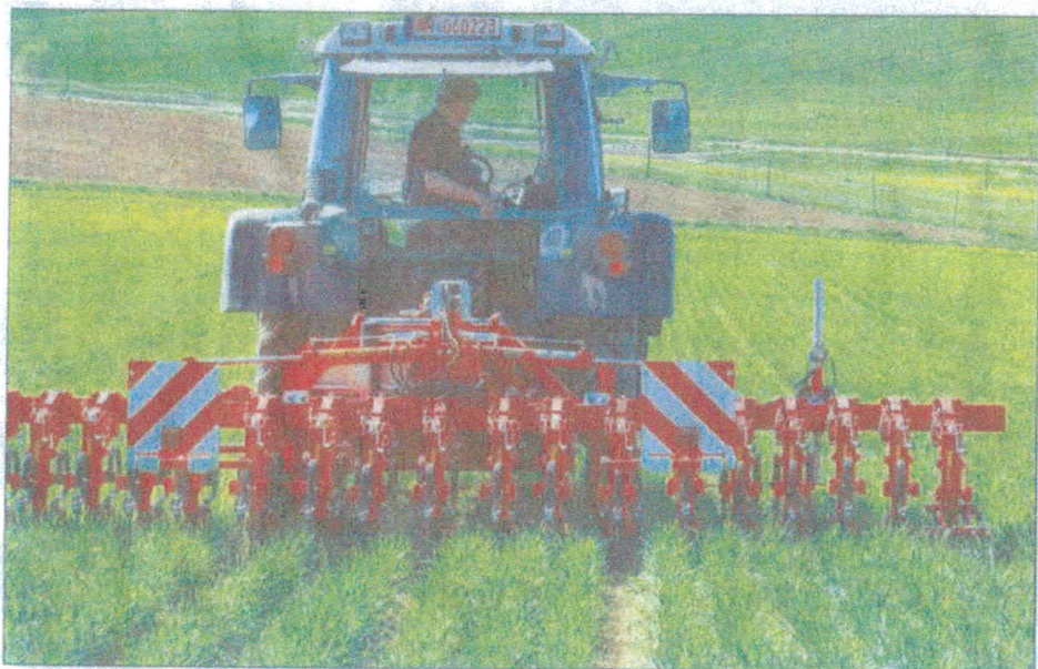
DER SCHLEPPER zieht das neuartige Hackgerät mit seinen 18 dreieckigen Scharen – zentimetergenau durch Kamera und Computer gesteuert – durch die Furchen. Foto: art
